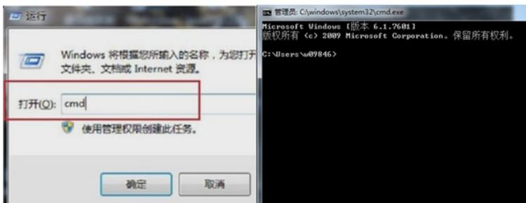
输入命令Telnet 设备管理IP，回车即可打开登录界面，先输入账号回车，再输入密码回车（注意：密码无回显），即可进入系统命令行。
