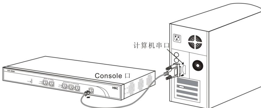
**电脑侧**: 1) 台式机使如下的COM口连接Console线的9针串口（如下图所示）
