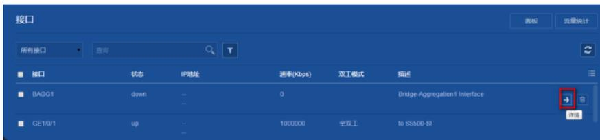
3) 设置链路类型为Trunk, Permit VLAN为10,20, 工作模式为二层模式, 点击“确定”
