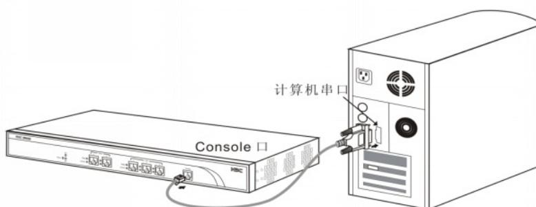
**电脑侧：**1) 台式机使如下的COM口连接Console线的9针串口（如下图所示）
