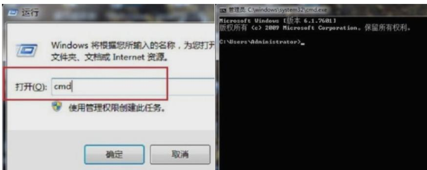
输入命令Telnet 设备管理IP，回车即可打开登录界面，先输入账号回车，再输入密码回车（注意：密码无回显），即可进入系统命令行。
