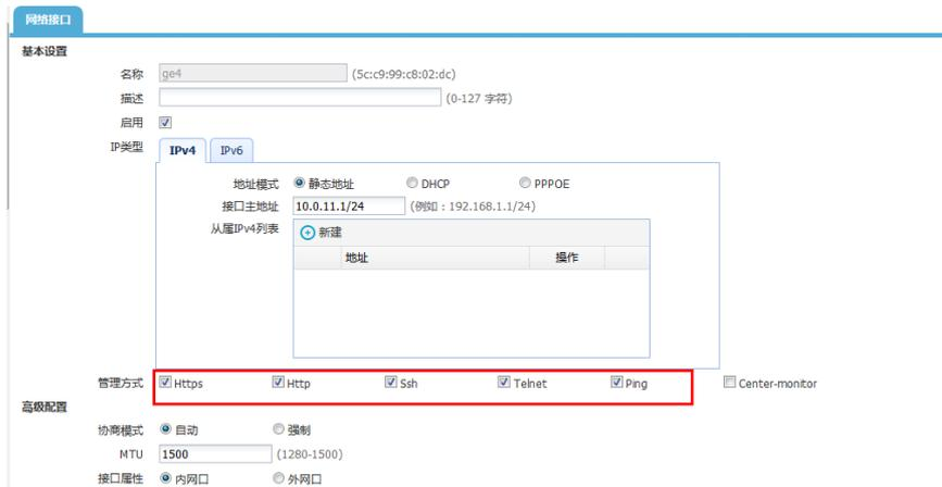
内网口已经开启ping功能，现场测试分支内网PC也能够PING通此接口地址；
