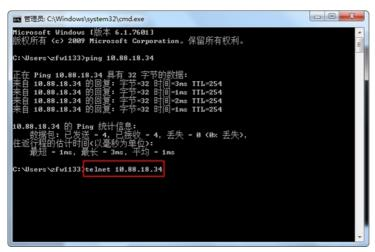
最好先进行ping测试,确认能ping通后再输入telnet 10.88.18.34进入设备管理界面。
