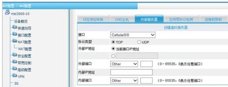
1. 选择接口为设备的外网口，协议类型选择TCP，外部IP地址一般选择当前接口IP地址即可，如果运营商分配了多个公网地址，也可以选择使用其他地址。外部端口可以任意填写，本例选择8080，内部IP地址填写内网WEB服务器地址192.168.1.100，内部端口选择内部服务器提供服务的端口号，本例为http服务，即80端口。配置完成后点击“确定”。
