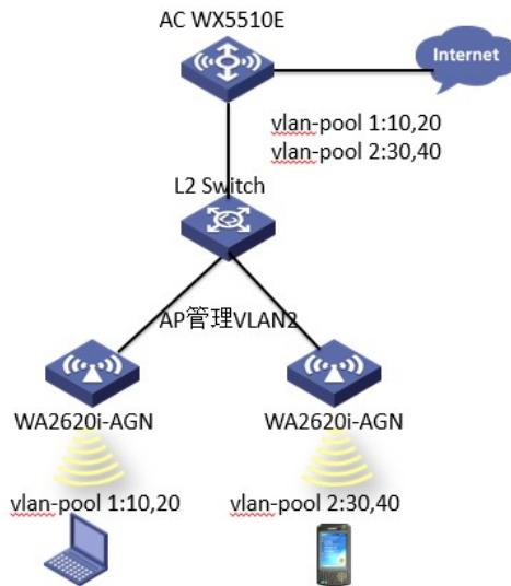
用户使用WX5510E+WA2620i-agn部署无线网络，客户不同楼层分属不同的部门，各部门通过接入无线vlan不同划分权限，考虑到后期各部门扩招接入用户增加，网络接入用户也需要增加，AP部署时已做好规划，后期涉及扩容地址池，现场使用vlan-pool方式给用户分配vlan，终端接入一个AP之后，vlan-pool将使用池中vlan轮流分给每个终端，这样终端可以均匀分配每个vlan地址，后期扩容可以将新vlan加入对应vlan-pool，扩容相对方便快捷。
