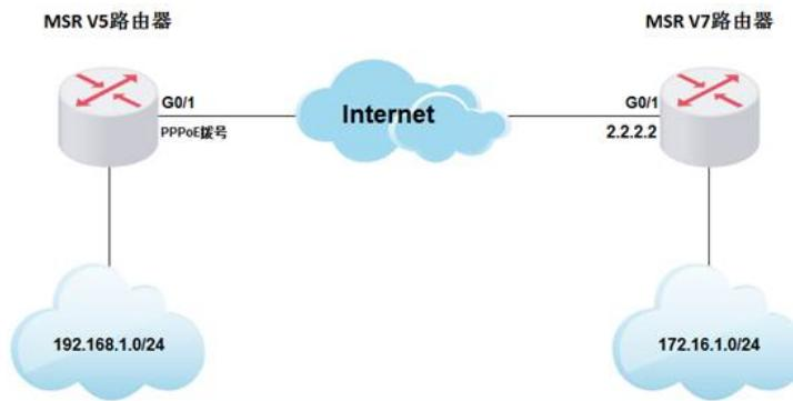
MSR V5路由器采用PPPoE拨号方式上网，IP地址不固定，MSR V7路由器采用固定IP地址上网，两台设备采用野蛮模式建立IPSec VPN保护内网互访的数据流。
