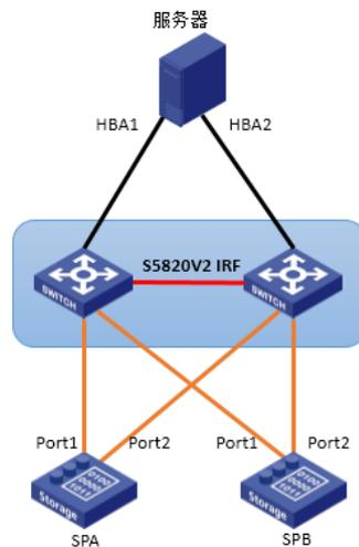
两台S5820V2做IRF，服务器的两块HBA卡分别连接到两台交换机上，SPA与SPB为存储设备，交叉互连至两台交换机。
