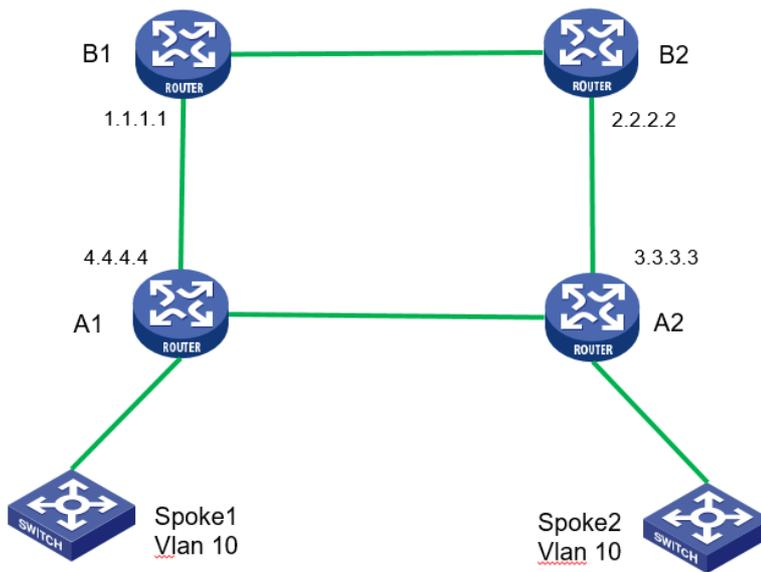
如图所示，本地已经部署一个IPRAN环网设备，两个办公楼分别位于A1/A2处，现在需要在A1-A2之间建立一条二层通道VLL，实现SPOKE1与SPOKE2之间的二层互通，两侧均在VLAN 10中。
