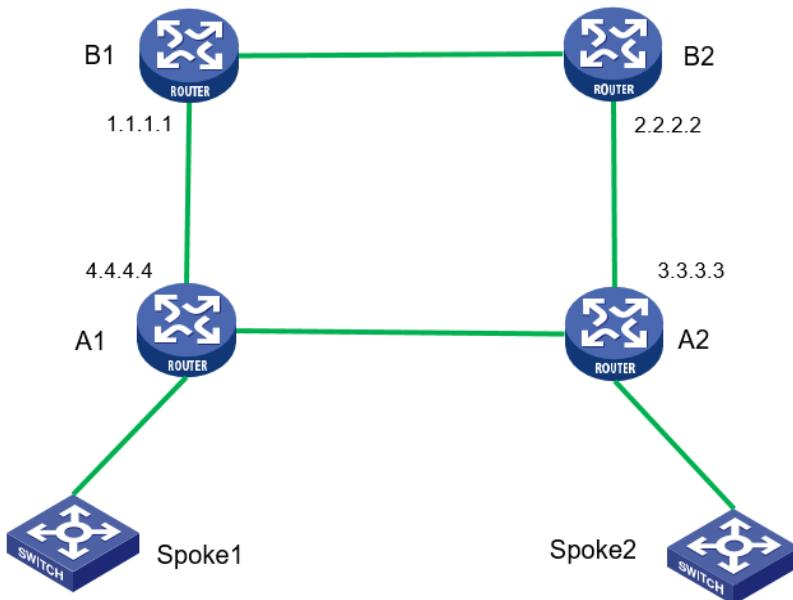
如图所示，本地已经部署一个IPRAN环网设备，两个办公楼分别位于A1/A2处，现在需要在A1-A2之间建立一条二层通道VLL，实现SPOKE1与SPOKE2之间的二层互通。两个分支的报文均不带Tag；
