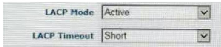
我司设备默认为长超时。两端超时时间不一致，导致本端端口频繁UP/DOWN
