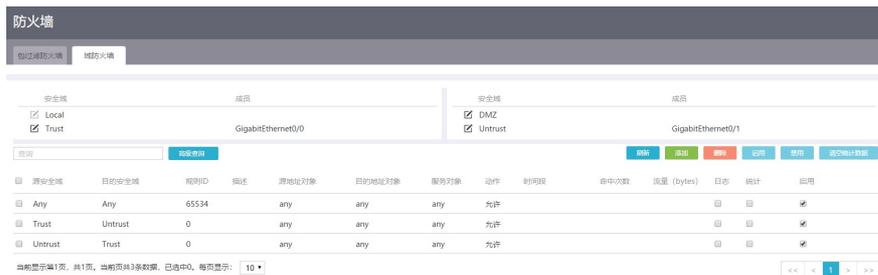
上述WEB配置，对应下发到设备命令行的配置如下。可以看到上网行为管理过滤icmp的app group是调用在Any-Any这个object policy里面，最后下发在Any到Any的域间策略中。而域防火墙对应的域间策略则是下发在Trust和Untrust这两个明细的域之间。
