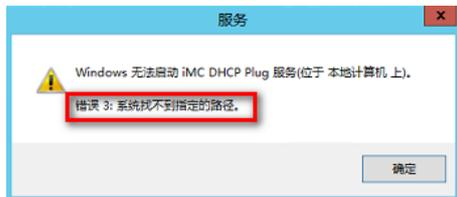
该局点 Director主机由于虚拟机中毒，故在后台安装了360安全杀毒软件查杀病毒。我们可以在360恢复区看到，dhcp-plugin插件被杀毒软件误杀了，导致dhcp-plugin插件不在指定路径，进一步导致iMC DHCP Plug服务无法正常启动。
