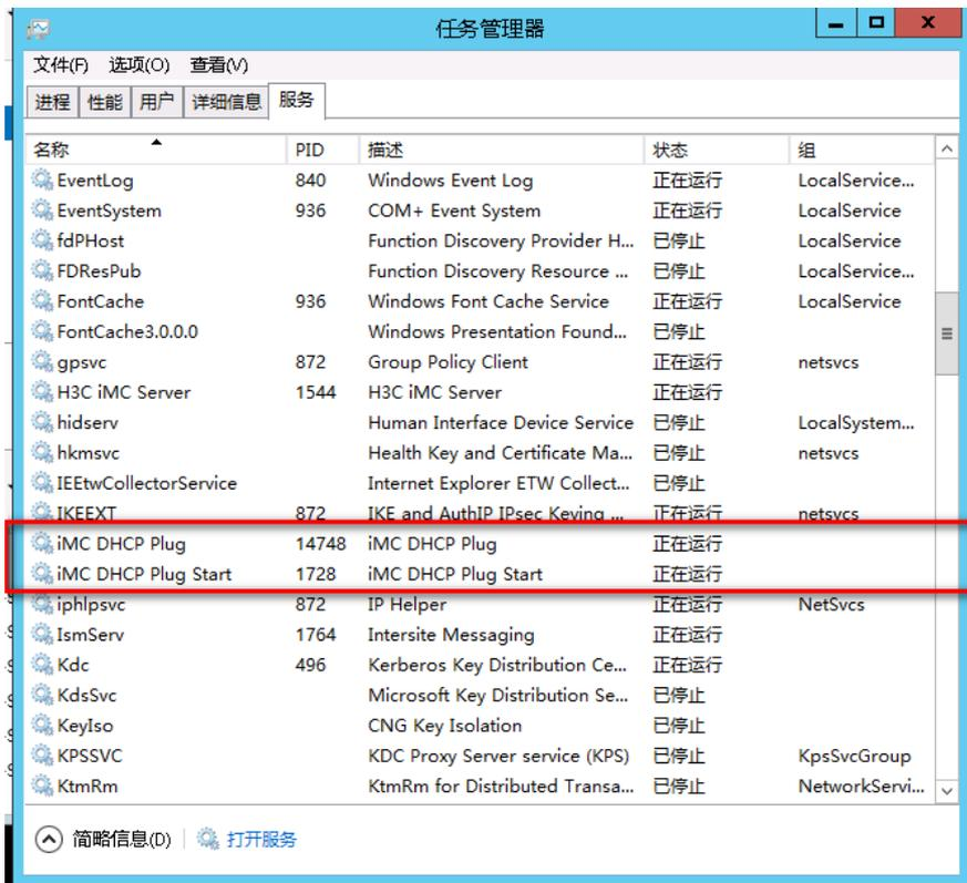
iMC DHCP Plug start进程用于监控iMC DHCP Plug进程，如果iMC DHCP Plug进程未正常启动，iMC DHCP Plug start进程会将其强行拉起。
