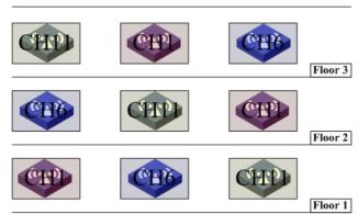
同时信道规划调整需要考虑三维空间的信号覆盖情况,无论是水平方向还是垂直方向都要做到无线的蜂窝式覆盖,最大可能的避免同楼层和上下楼层间的同频干扰。
