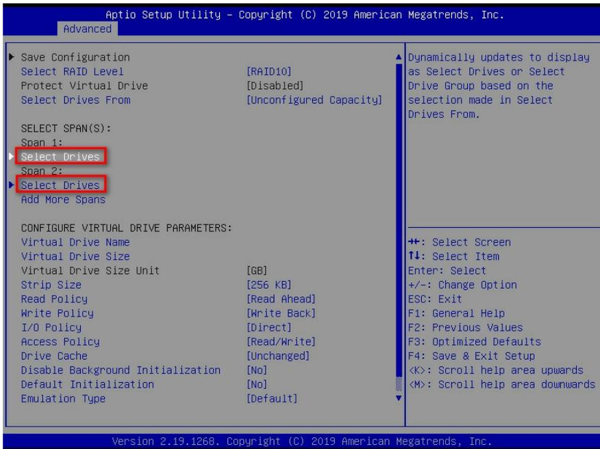
3. 可以看到每个span中添加了2块硬盘，下面的逻辑盘配置可根据需要修改，save configuration。
