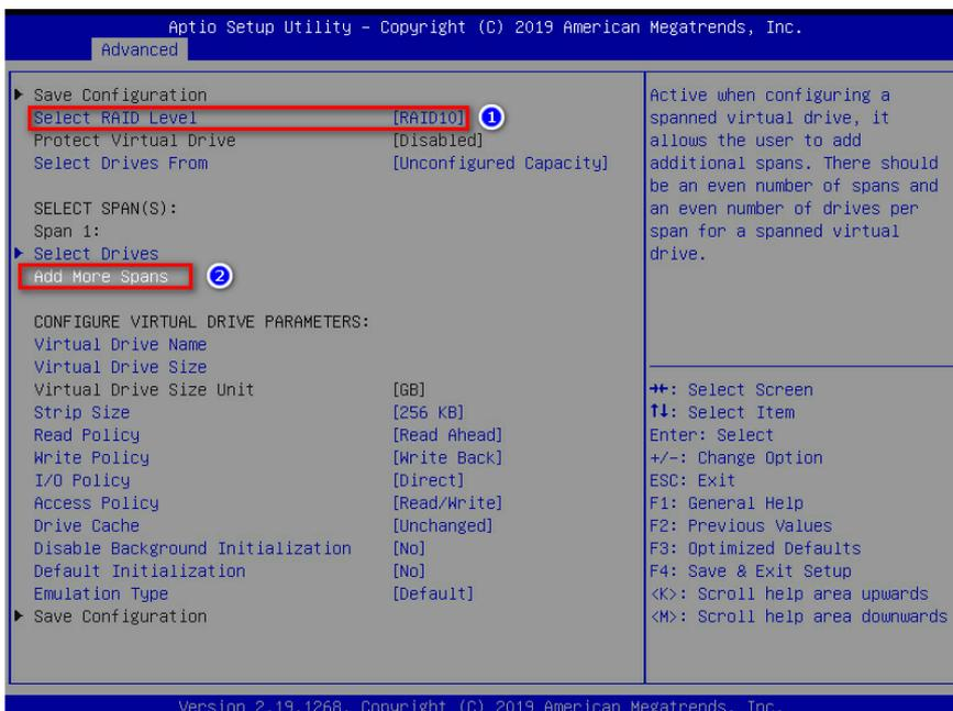
2、创建了2个span，然后在每个span中添加硬盘。
