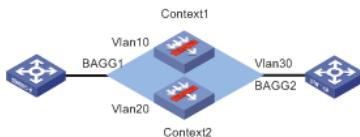
如上拓扑所示，vlan10的网关在虚墙1，vlan20的网关在虚墙2，两个虚墙都通过vlan30与上行交换机互联。
