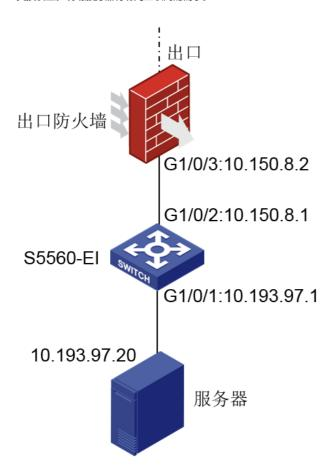
现场使用内网服务器访问外网不通,然后首先进行分段测试,发现服务器无法正常ping通防火墙, 从防火墙也无法ping通服务器。具体ping测试情况如下。
