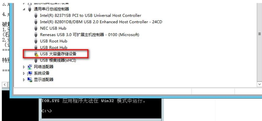
2、虚拟机添加USB选择驱动时，可以对比接入USB后哪个驱动项目增加了，再对应选择即可
