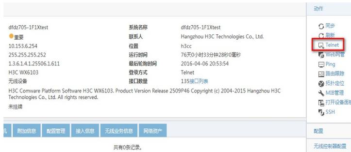
iMC页面上执行telnet操作的过程，实际上是调用客户端电脑上的telnet程序，通过iMC作为跳转机后台登录设备的，所以客户端电脑如果没有安装telnet程序或者程序启动异常就会导致执行失败。
