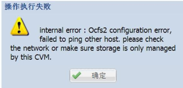
现场工程师将两台正在使用并且挂载了共享文件系统的CVM主机做双机热备，导致双机热备配置失败，致使CAS界面无法正常登入。熟悉CVM双机热备配置的工程师应该知道，双机热备只能在开局环境下配置，并且这两台CVM主机一旦作为双机热备时就不可再作为CVK主机使用，也就不能挂载共享文件系统。
