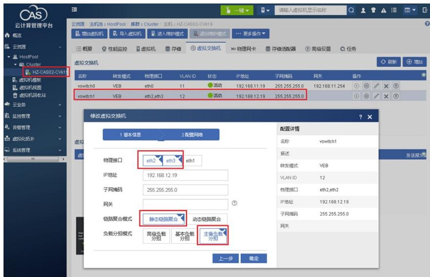
步骤2: 登录CVK主机后台执行ifconfig命令，查看网卡eth2的mac地址为“FC:15:B4:1C:AD:79”，网卡eth3的mac地址为“FC:15:B4:1C:AD:7D”。内核端口vswitch1的mac地址为“FC:15:B4:1C:AD:79”，说明CVK对外发送的报文会被封装mac地址“FC:15:B4:1C:AD:79”。
