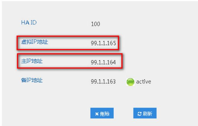
因此怀疑是虚IP分别下发到两台成员设备上，出现了IP冲突，导致了VCFC连接License Server异常。在两台成员设备上均执行ip address命令，发现的确均存在99.1.1.165这个虚IP。如下图所示：
