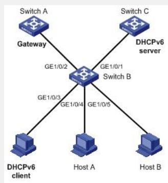
Switch B通过以太网端口GigabitEthernet1/0/1连接到DHCPv6服务器，通过以太网端口GigabitEthernet1/0/3连接到DHCPv6客户端。用户Host A和Host B通过Switch B接入网关Switch A。
