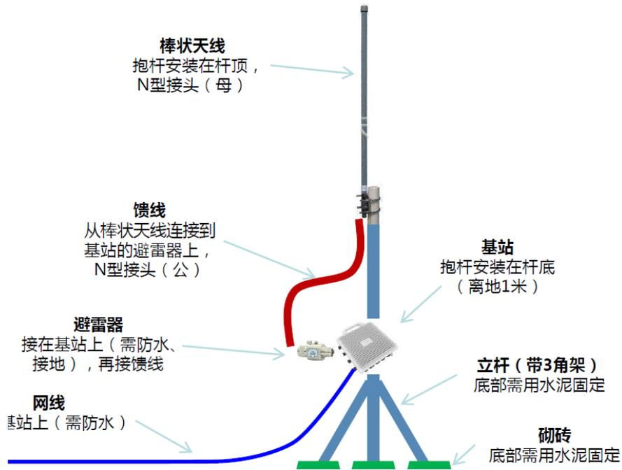
由于现场业务需求，Lora 天线还可以安装在电线杆上，跟天线要有一定隔离度，大概50cm左右，如下图所示：
