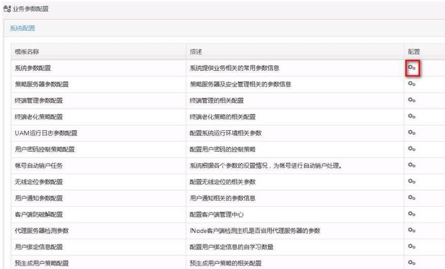
(4) 在弹框的“用户数据管理参数”一栏中，点击下拉“密钥显示方式”，选择“明文（显示实际的密钥）”，然后点击“确定”。（待后面查完radius客户端侧的共享密钥，需将该参数改为“密文（显示为\*\*\*\*\*）”）如下图所示：
