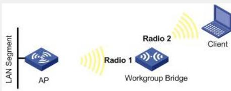
Workgroup Bridge同时使用两个Radio口组网图
