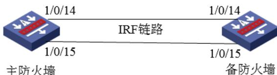
组网说明：将主防火墙的14与15接口和备用防火墙14与15接口互联组成IRF链路。
