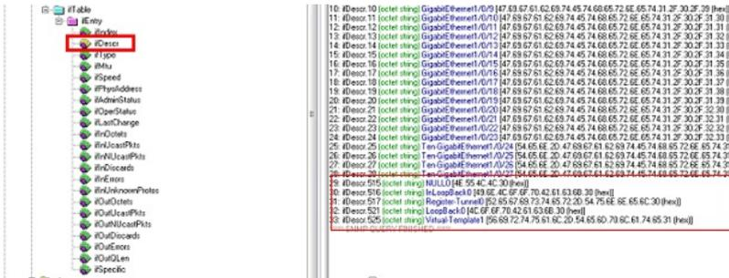
排查设备配置中发现客户在设备上使能了L2TP VPN，测试发现L2TP VPN用户登录后该告警就会产生，基本可以判断此UP/Down端口与L2TP有关。
