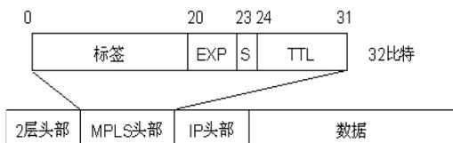
其中的EXP位占3个bit，和IP报文中的TOS域使用的ip precedence值类似，所以我们把它定义为mpls报文的优先级。如何实现呢，做一个映射关系，IP报文中的TOS值是多少，在添加标签时将其拷贝一份到标签的EXP中，当有多层标签时，外层标签也复制一份。而在MPLS VPN的骨干域中，我们可以读取MPLS中的EXP位来实现标签转发中的报文优先和拥塞管理功能。
