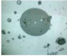
LD端面严重污染，厂家简单清洗端面后复测光模块值为-5dBm，故障排除。清洗后端面如下所示：
