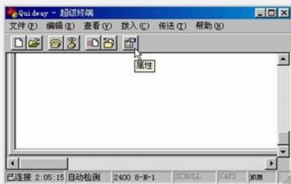
(4) 在超级终端属性对话框中选择[设置]一项，进入下图所示的属性设置窗口。选择终端仿真为VT100，单击[确定]按钮。
