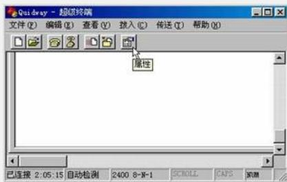
(2) 在超级终端属性对话框中[连接时使用]一栏选择连接的串口。选择的串口应该与配置电缆接的串口一致。单击[配置]按钮。
