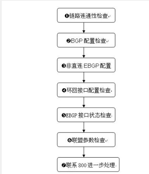
图1 BGP邻居无法建立故障处理流程
