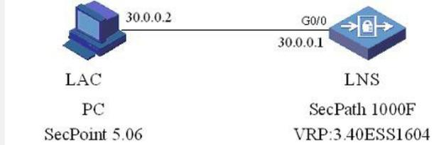
如图所示，用户PC作为LAC，使用我司SecPoint作为客户端软件，拨号接入到对端的SecPath防火墙。
