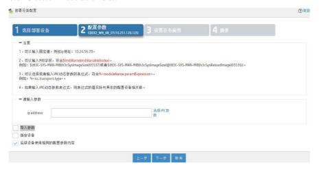
对需要进行配置下发的设备的ip地址信息进行提取导出,然后编辑相关导出文件后,再导入到系统中,ip地址的变量就会是需要替换的设备管理ip地址信息了。操作如下:
