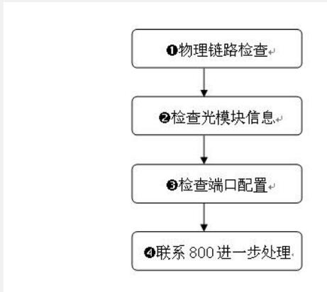
图一、RPR对接不成功故障处理流程
