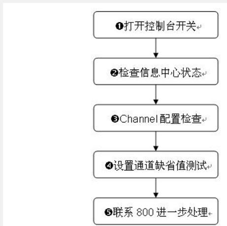
图一、控制台和监视终端收不到信息故障处理流程
