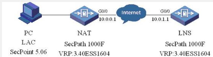
如图所示，用户PC作为LAC，使用我司SecPoint作为客户端软件，拨号接入到对端的SecPath防火墙。
