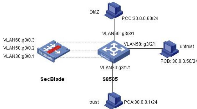
SecBlade板工作在透明模式，S8505作为二层交换机，g3/1/1属于vlan30，g3/2/1属于vlan50，g3/3/1属于vlan60。
