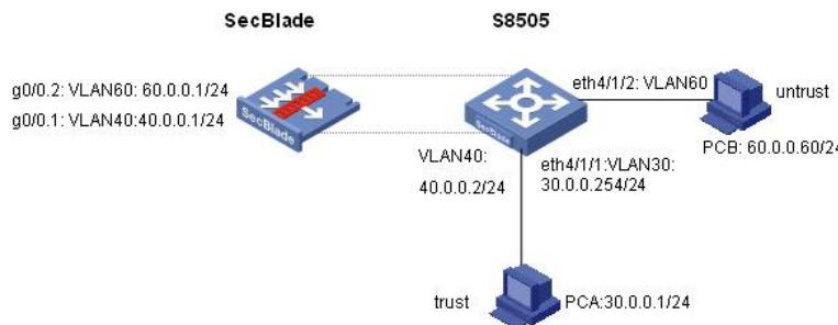
要做NAT网关，SecBlade板只能工作在路由模式，S8505创建三层接口int Vlan-interface 40，作为与SecBlade的内部接口，内网PCA的网关在S8500上。防火墙板作nat，使trust区域的用户能访问公网，外网用户能通过公网地址访问DMZ区域的服务器。
