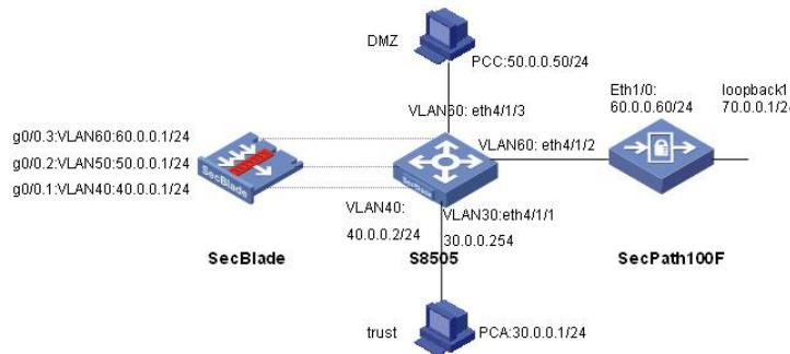
SecBlade单板和untrust区域的SecPath100F建立GRE，保护数据流30.0.0.0/24<-->70.0.0.0/24。同时，trust区域用户能访问公网资源，DMZ区域的服务器能对外提供服务。
