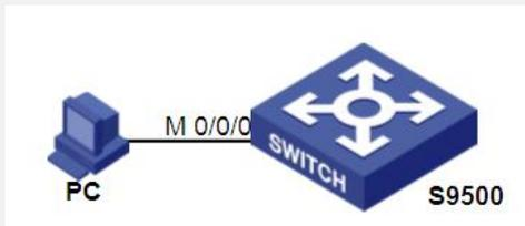
上图中, 将PC机的以太网口通过双绞线连到S9500交换机的M-Ethernet 0/0/0口上, 同时PC机通过配置线缆连到S9500的Console口上。
