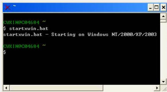
弹出Xwindow视窗, 在Xwindow界面执行如下操作, 启动XE 7000客户端控制程序。注意大小写, 第四行中PC IP 地址后面要加上“: 0”。
