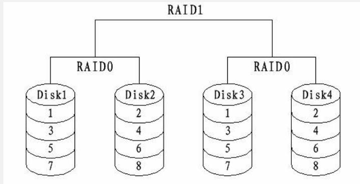
RAID0+1，也叫RAID10，即先对两块磁盘分别作RAID1，然后再将两部分作RAID0，如图所示：
