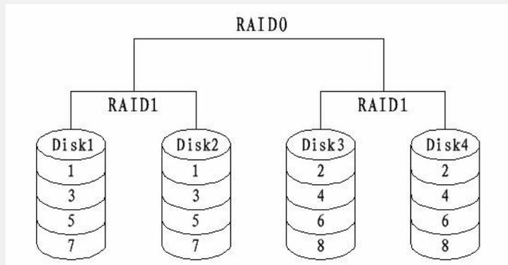
RAID0+1要比RAID1+0的可靠性高很多，以文中所述的两种情况为例，当有两块磁盘同时发生故障的时候，RAID0+1有1/3的可能性导致数据丢失，而RAID1+0则有2/3的可能性导致数据不可用。
