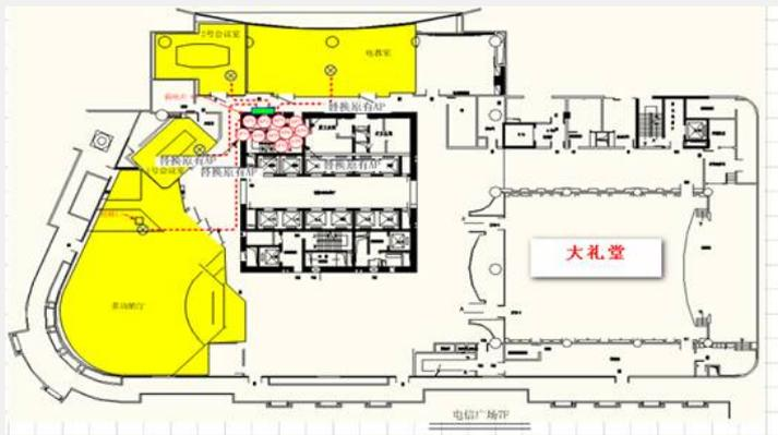
由于会议室空间较大，分为上下两层座席区，可同时容纳600人，假设在举行会议时有40%的用户同时使用网络，则使用WLAN网络的用户数为200人左右，根据一个AP（这里使用802.11n的AP）在没有干扰的情况最多可以让35个用户正常上网来计算，至少需要6个AP来覆盖整个会议室。建议一共放装6个室内AP，一层座席区3台AP采用全向天线进行覆盖，主席台方向2台AP采用定向天线覆盖一层前端坐席，二层座席区再放置1台AP覆盖二层坐席区。平面图如下：
