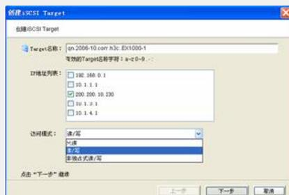
在创建iSCSI Target对话框中输入将要新建的Target名称 (如h3ci该名称全球唯一。在小范围内使用可以选取一般的英文名称), 并在相应的IP地址列表前打“√” (说明: 第1个IP地址为管理口地址, 后四个口为业务口地址, 客户端可通过被选的网口来连接Target)。访问模式有三种, 当Target与SAN资源绑定后, 只读模式和读/写模式下绑定的资源被此Target独占, 该资源不能再被绑定到其他Target, 只读模式下对资源只有读的权限, 读/写模式下对资源有读和写的权限, 非独占式读/写模式指绑定的资源可以被其他的Target绑定, 共享SAN资源。但是必须要用第三方的专门软件, 否则极有可能造成读写错误。
