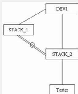
组网图如上图, STACK\_1和STACK\_2之间是聚合链路。通过Tester进行MAC地址攻
